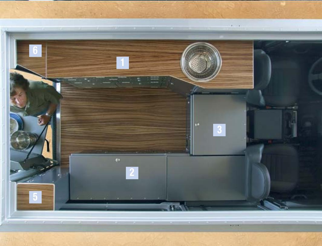
Man muss die Sache mal von oben betrachten, um zu erkennen, wie durchdacht Ex-Tec den Innenausbau eines Defenders bis ins letzte Detail umgesetzt hat. Die **7** Stromversorgung ist so integriert, dass sie sowohl von außen bei offener Hecktür als auch von innen leicht zu erreichen ist. Expeditions-„feeling“ vermittelt die Materialwahl von hochwertigem **8** Zebrano-Schichtholz für Boden und Arbeitsflächen.
